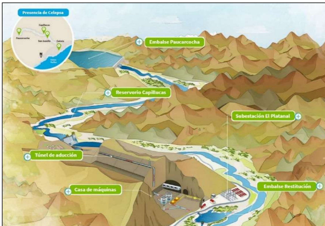
Gráfico N° 1: Diagrama del Proceso Operativo de la Compañía Eléctrica El Platana S.A. CELEPSA
