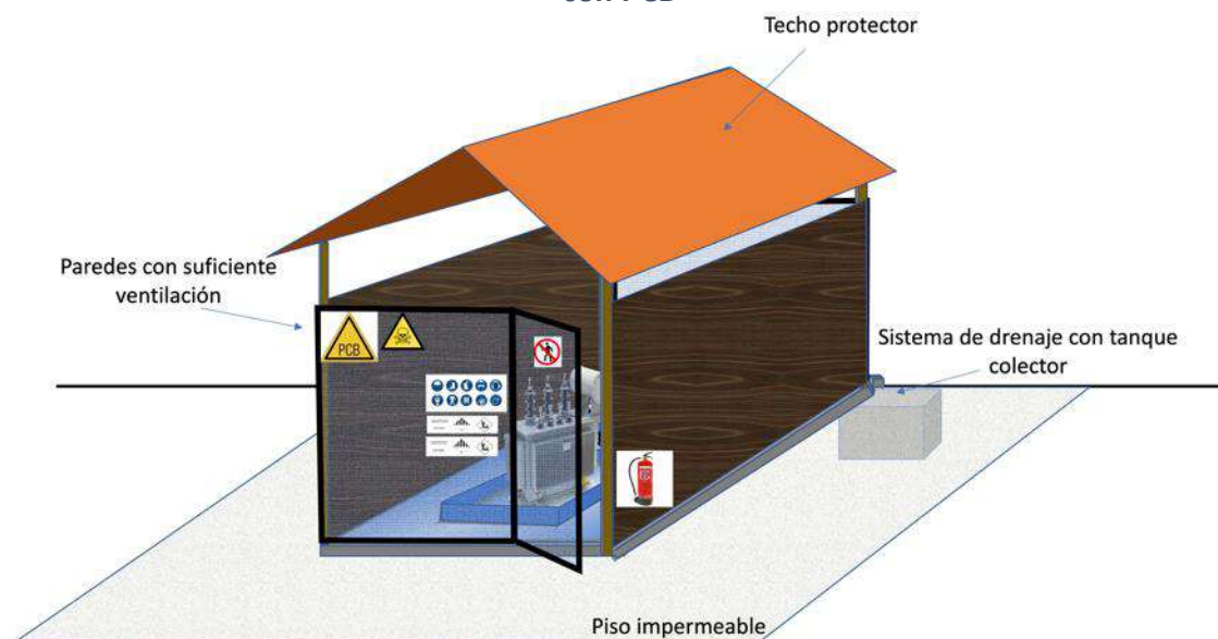
Gráfico N° 21: Características básicas para almacenamiento de existencias y residuos con PCB
