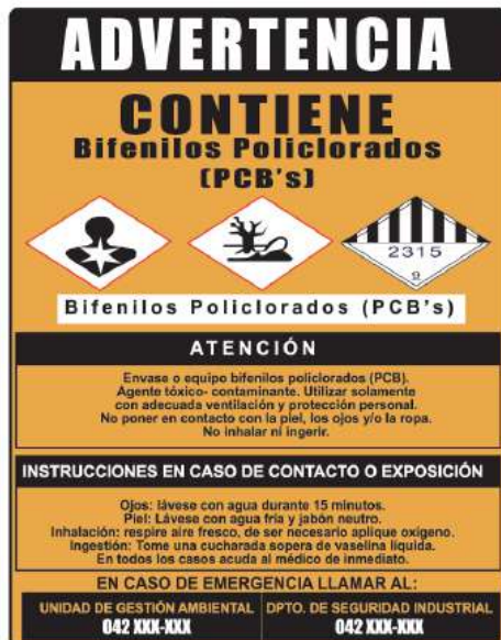
Gráfico N° 23: Etiquetas para equipos y contenedores que poseen aceite dieléctrico contaminado y libre de PCB
