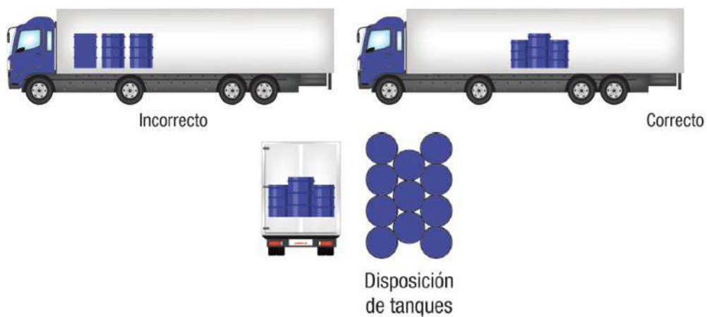
Gráfico N° 20: Peso y disposición de los contenedores para sólidos y líquidos contaminados con PCB
